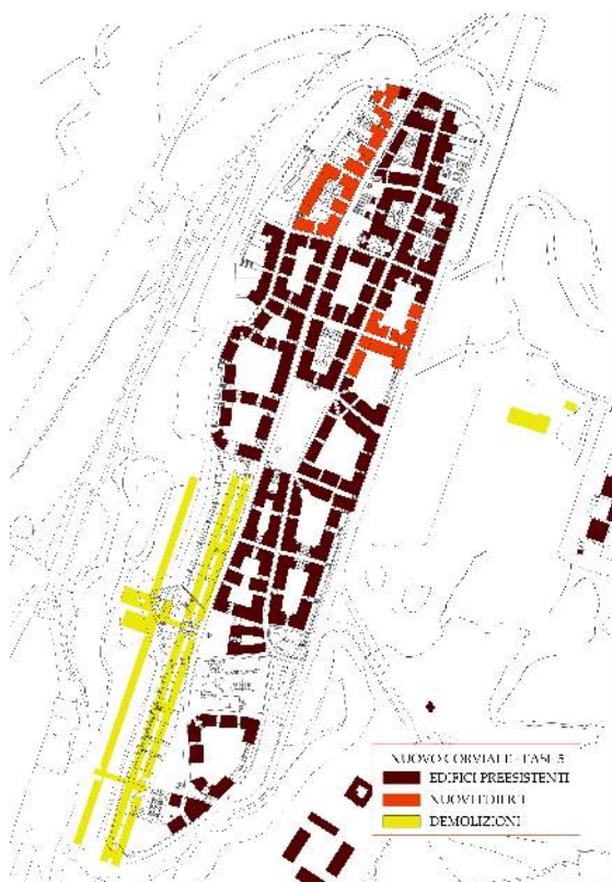
Fase 5 – si costruiscono altri lotti e si terminano le demolizioni.
